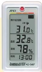
温度と湿度を常時測定し、インフルエンザ流行の危険ランクを2段階で表示。さらに、暑熱環境の危険ランクも4段階で表示します。危険域になるとアラームが鳴るため、1年中、健康管理に役立てることができます。
